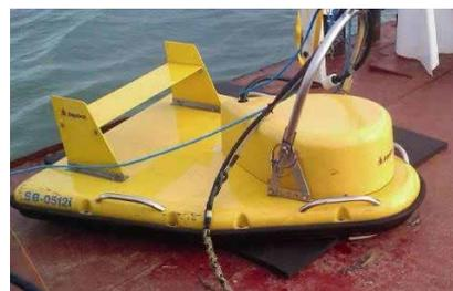
▲ Engin de prospection sismique tracté par un bateau
