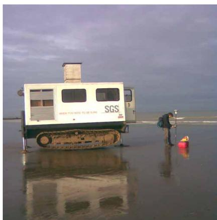
▲ Tests de pénétration de cône sur la plage de Raversijde (doc. UGent).
